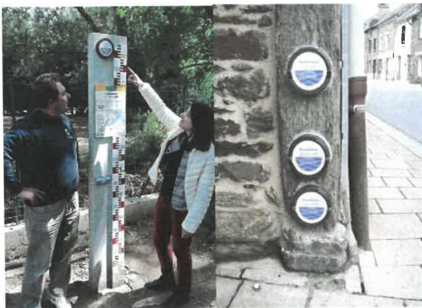
Figure 600 : exemples de repères de crue sur support propre (à gauche, couplé avec échelle et panneau didactique) ou intégrés au bâti (à droite)
