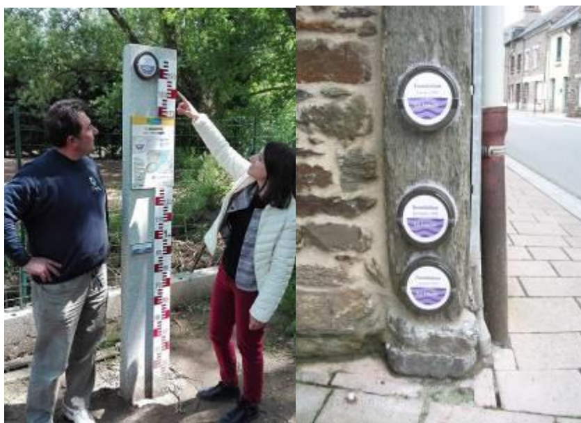
Figure 2 : exemples de repères de crue sur support propre (à gauche, couplé avec échelle et panneau didactique) ou intégrés au bâti (à droite)
