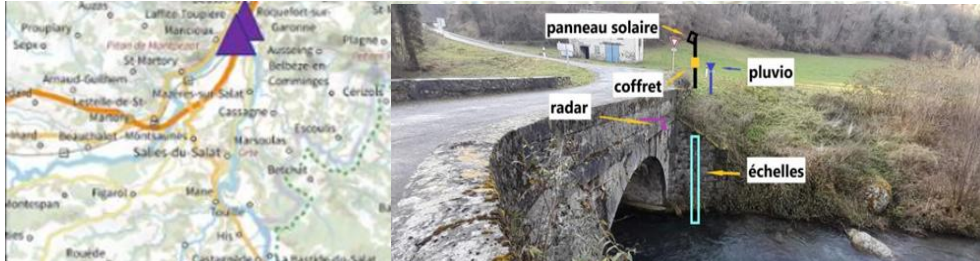
Schéma d'installation du SAL d'Augirein
